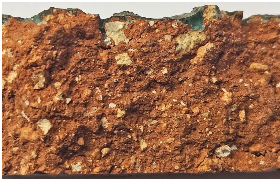
Fot 8. Odlamany fragment kompozycji nr. 3 znaleziony nad podwieszonym sufitem. Widoczna niejednorodna struktura ceramiki. Fot. A. Kłosowska, marzec 2024
