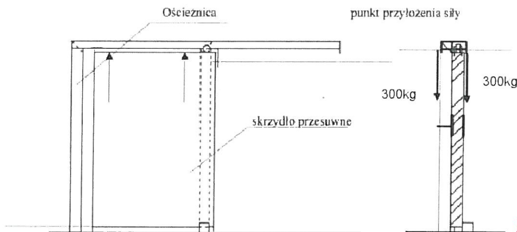
Rys.13. Schemat badania odporności na obciążenie statyczne pionowe
