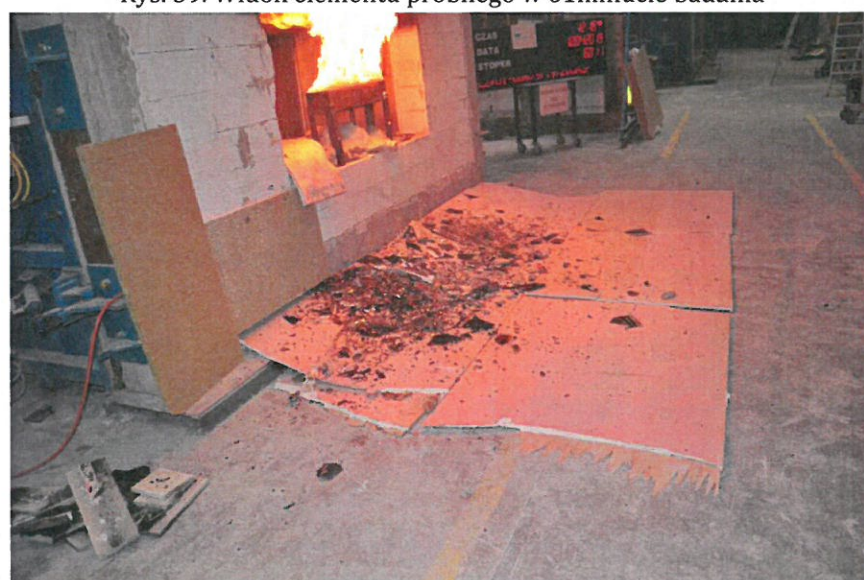
Rys. 40. Widok elementów które odpadły podczas badania – po lewej elementy ważone
