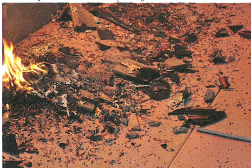
Rys. 34. Widok elementów które odpadły do 17 minuty badania
