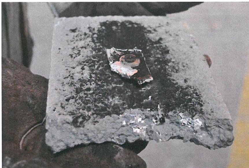
Rys. 26. Widok elementów które odpadły w 5 minucie badania
