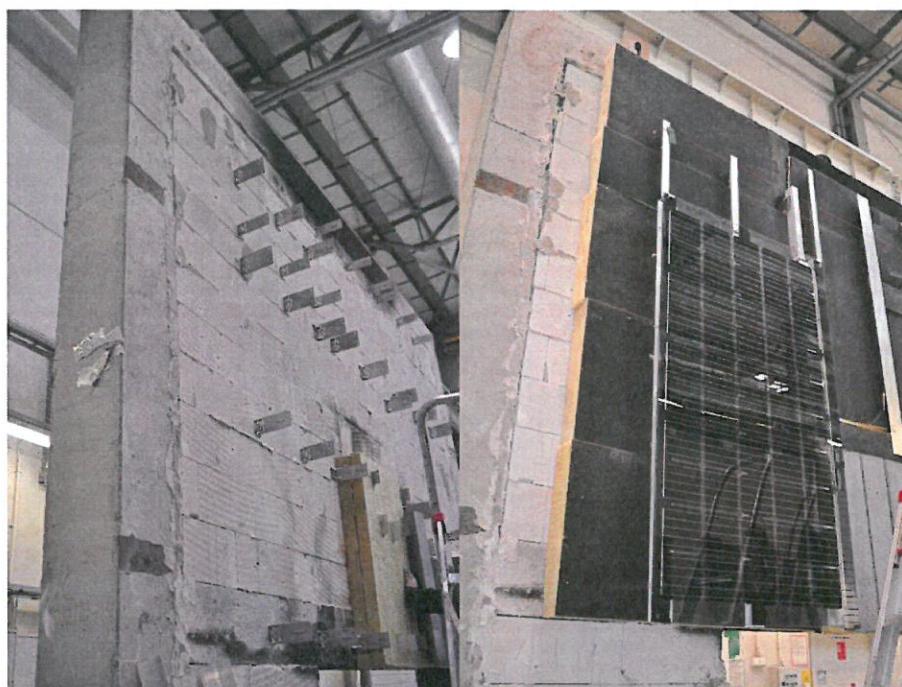
Rys. 16. Widok montażu konsol i okładzin
