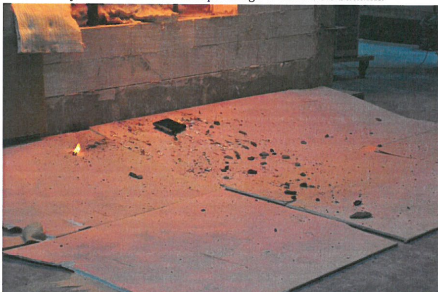
Rys. 24. Widok elementów które odpadły w 4 minucie badania
