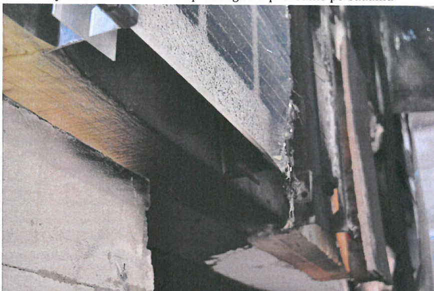
Rys. 42. Widok elementu próbnego po badaniu - detale
