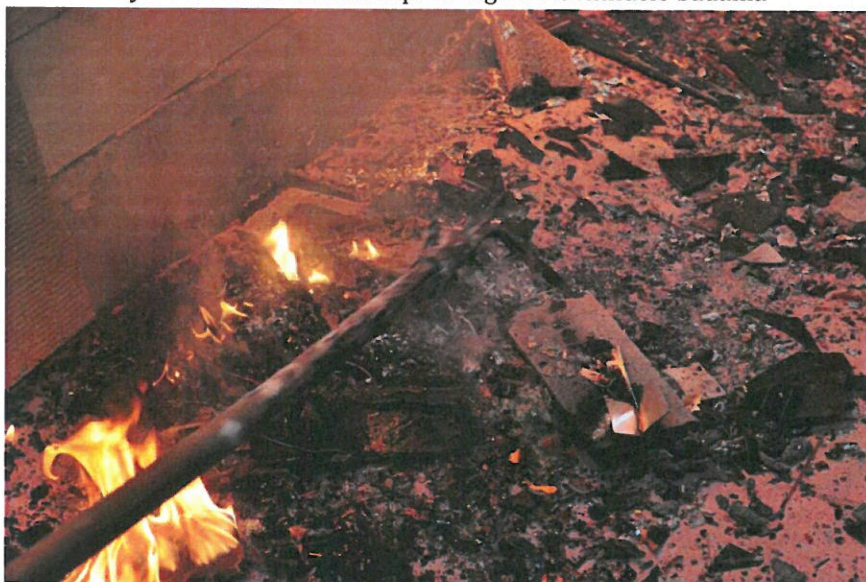
Rys. 36. Widok elementów które odpadły do 26 minuty badania
