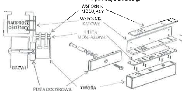
3.3. Schemat montażu do ościeżnicy za pomocą elementu „Z” (ZL)
