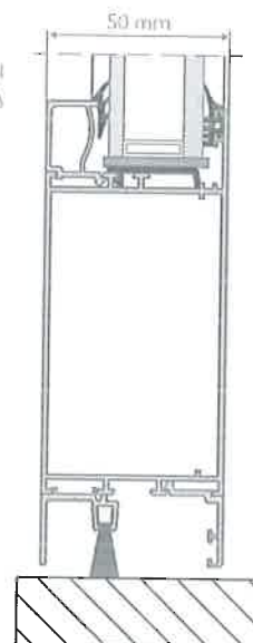
PRZĘKÓJ PRZĘZ DRZWI ZE SZCZÓTKĄ
