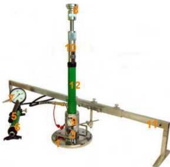
Rys. 1.2 Aparatura VSS z jednopunktowym pomiarem przemieszczenia płyty
