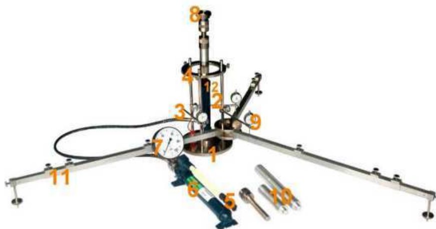
Rys. 1.1. Aparatura VSS z trzypunktowym pomiarem przemieszczenia płyty
